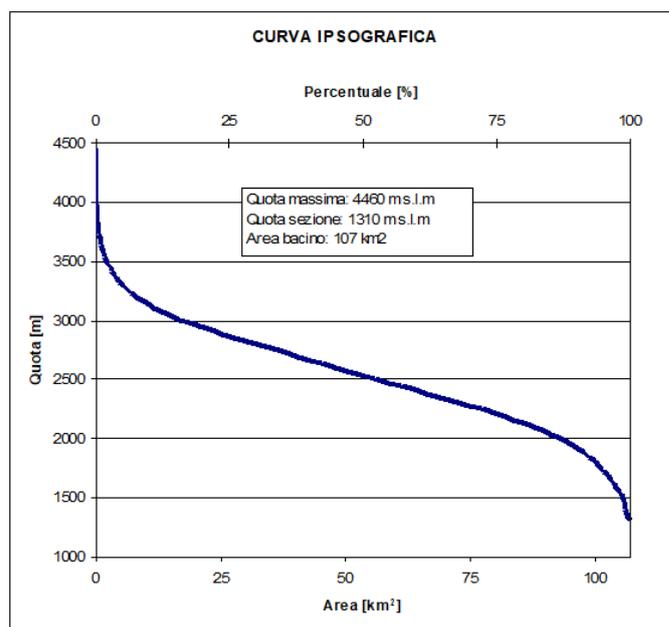
Curva ipsografica del bacino sotteso dalla sezione idrometrica di Valtournenche - Maen.
